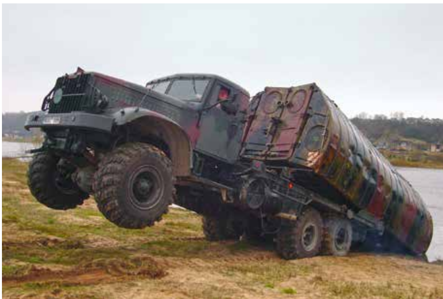
2008 m. Perkėlų kuopos pratybos Pavilkyje. Į vandenį įleidžiama pontono dalis. PjVIB nuotr.
