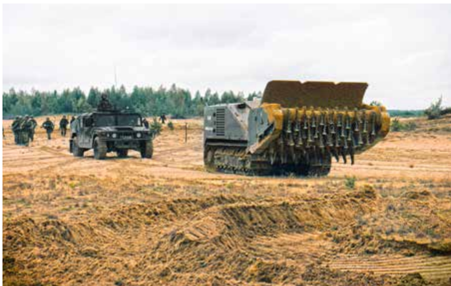
2016 m. Išminavimo robotas MV-10 užtikrina sklandų karių ir technikos judėjimą per minų lauką. PJVIB nuotr.
