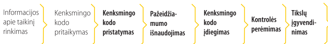
10 pav. Pažeidžiamų interneto svetainių kibernetinių incidentų klasifikavimas pagal „Cyber Kill Chain“ modelį
