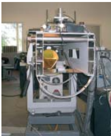
Vidurinės infraraudonosios spektro srities lidarai, sukurtas Fizikos institute, bendradarbiaujant su lazerius gaminančia įmone EKSPLA, vykdamą projektą LISATNAS.
